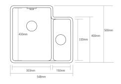
BOWL DEPTH: 200MM OVERALL SINK DEPTH: 225MM MIN. BASE UNIT: 600MM
